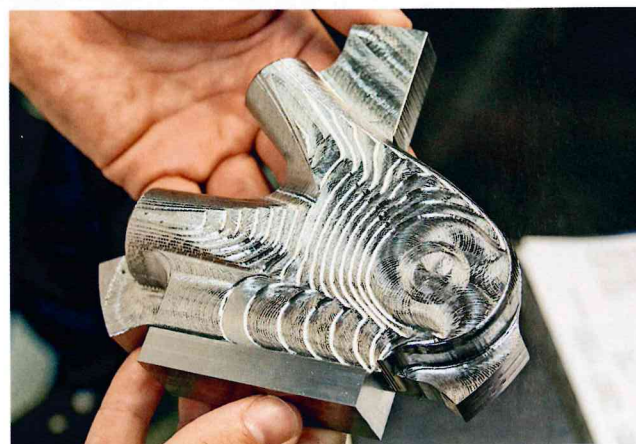
In zwei Schritten zum perfekten Teil: Gelenk für die Radaufhängung nach dem Schruppen (oben), geschlichtet (unten).
